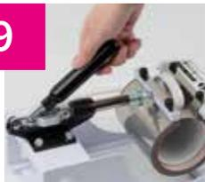
Ziehen Sie den Hebel nach vorne und schließen Sie die Presse.
