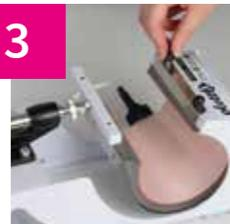
Tipp: Achten Sie beim Einsetzen eines neuen Aufsatzes darauf, diesen zuerst mit beiden Schrauben auf der linken Seite zu montieren.
