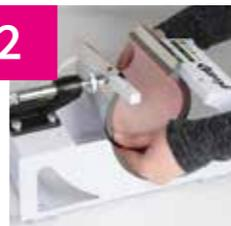
Ziehen Sie den Hebel nach hinten, um die Presse zu öffnen und entfernen Sie den Aufsatz aus dem Metallgestell.
