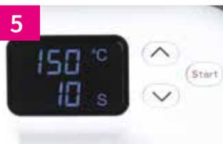
Una vez que haya ajustado los valores deseados para la temperatura y el tiempo, la prensa se precalienta a la temperatura deseada. Ahora espere hasta que el indicador de temperatura haya alcanzado la temperatura ajustada.
