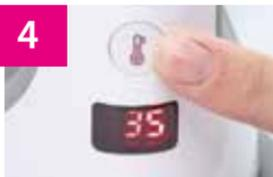
Para ajustar la temperatura de transmisión deseada, pulse el botón Temp. La temperatura de transmisión ajustada actualmente comienza a parpadear en la pantalla digital. Pulse ahora el botón Temp varias veces hasta que aparezca la temperatura deseada.
