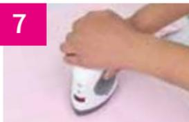
Ahora presione la iXpress Mini 2 sobre su diseño - Para aumentar la presión, coloque ambas manos una encima de la otra sobre la prensa térmica e inclínese ligeramente sobre el dispositivo. Tenga en cuenta que, dependiendo del fabricante, la temperatura y el tiempo de prensado pueden variar.
