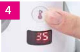
Per impostare la temperatura di trasmissione desiderata, premere il pulsante Temp. La temperatura di trasmissione attualmente impostata inizia a lampeggiare sul display digitale. A questo punto, premere ripetutamente il pulsante Temp finché non viene visualizzata la temperatura desiderata.
