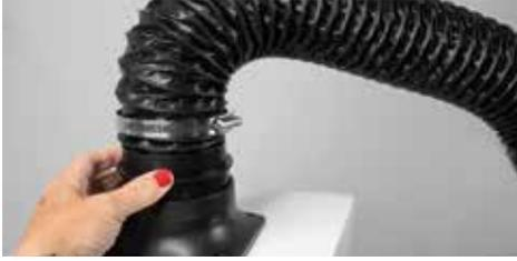
Nehmen Sie den Schlauch Ihres Lasers und befestigen Sie ihn mit dem geeigneten Schlauchadapter auf dem Gerätecover.
