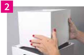
Placez les éléments filtrants (tapis préfiltre / filtre intermédiaire / filtre principal) dans votre purificateur de fumée. – Voir illustration ci-dessous.
