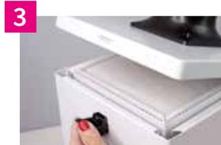
3 Richiudere il coperchio utilizzando le maniglie di serraggio. Assicurarsi che il coperchio sia posizionato correttamente e chiuso saldamente.
