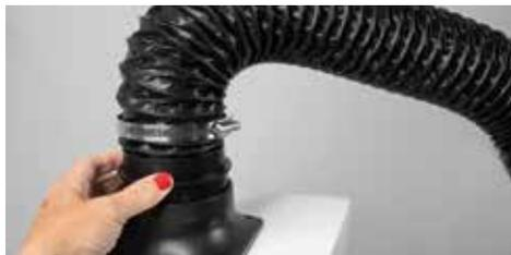
Prendere il tubo flessibile del laser e collegarlo al coperchio del dispositivo utilizzando l'apposito adattatore.
