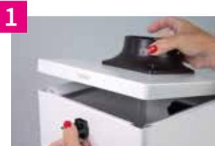
1 Apri le maniglie di fissaggio sui lati del purificatore di fumo e rimuovi il coperchio.
